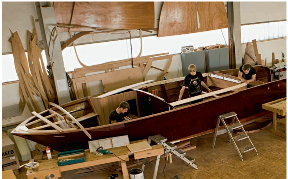
Ist so gross wie ein kleiner Garten, kostet so viel wie ein mittelgrosses Haus: ein Run-about von Pedrazzini in Bäch am Zürichsee, das von gelernten und angehenden Bootsbauern gefertigt wird. Allein der Beschlag am Bug – das Paradestück der Bootsbauerkunst – nimmt über 20 Arbeitsstunden in Anspruch (siehe Portrait Seite 46).
